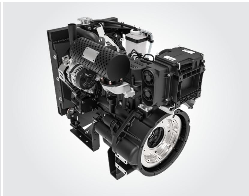
Die Motoren mit variabler Drehzahl sind zudem auch als Fan 2 Flywheel Version verfügbar. Diese findet vor allem für Anwendungen mit zusätzlicher Hydraulikölkühlung Verwendung.
